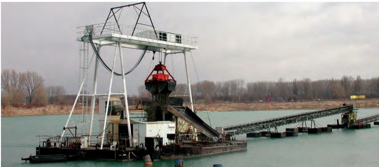
Kiesgewinnung mit Schwimm-Greifbagger (W. Kuhn, LGB)
